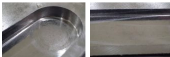
插铣 → 横向加工 Plunging Horizontal Milling
