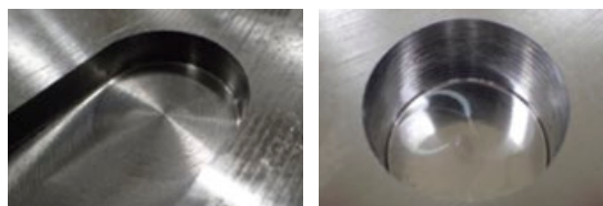
斜面加工 Ramping
